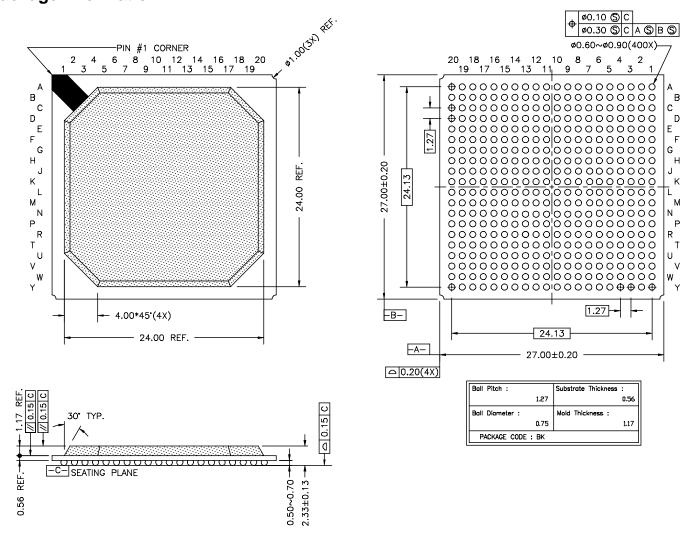
Figure 21. KSZ9692PB 400-Pin PBGA (24X24X2.33 MM)
